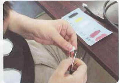
2つめのコネクタを付ける作業では、1人で全色の電線を差し込むので、間違えないように順番を図で確認します。
